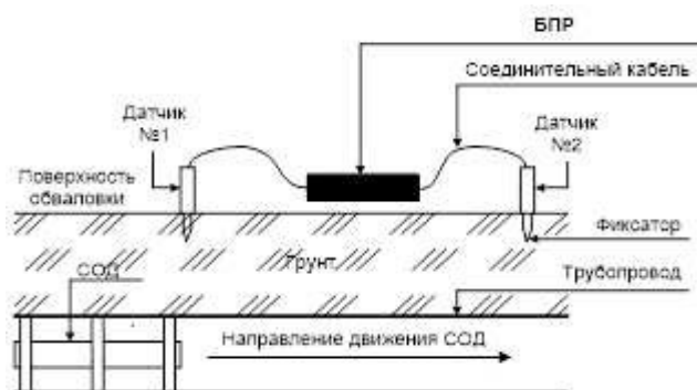
Рисунок 6 – Схема установки переносного сигнализатора исполнения «РЕПЕР-3В».
