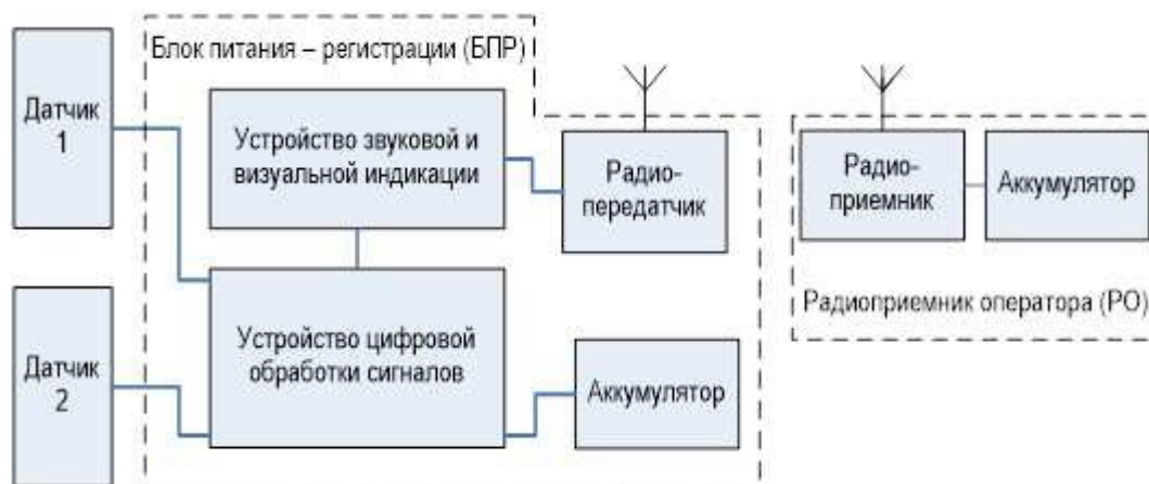
Рисунок 3 – Функциональная схема переносного сигнализатора исполнения «РЕПЕР-3В»
