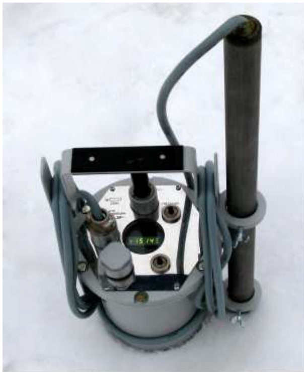
Рисунок 2 – Внешний вид сигнализатора исполнения «МДПС-3Р».
